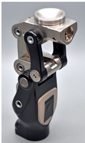
Obr. 3.8 Ukázka víceosého protetického kolenního kloubu. Tento model je určen pouze pro chůzi. Jeho součástí je i zamykací mechanismus, který se při zatížení končetiny s protézou aktivuje a koleno bezpečně zafixuje. Při přesunutí váhy na druhou končetinu se mechanismus odemkne, což umožní provedení švihové fáze chůze.
